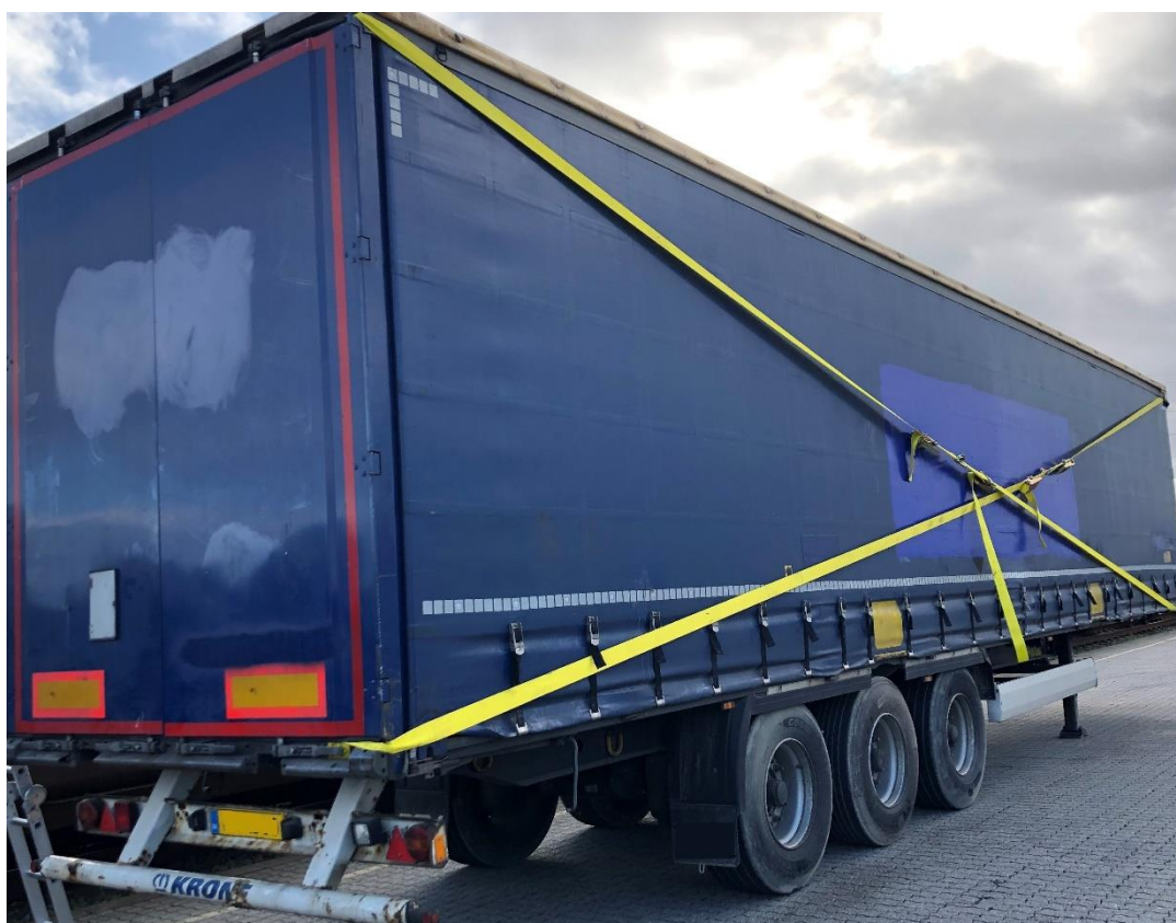
Figur 65: Opstilling til trækforsøg
