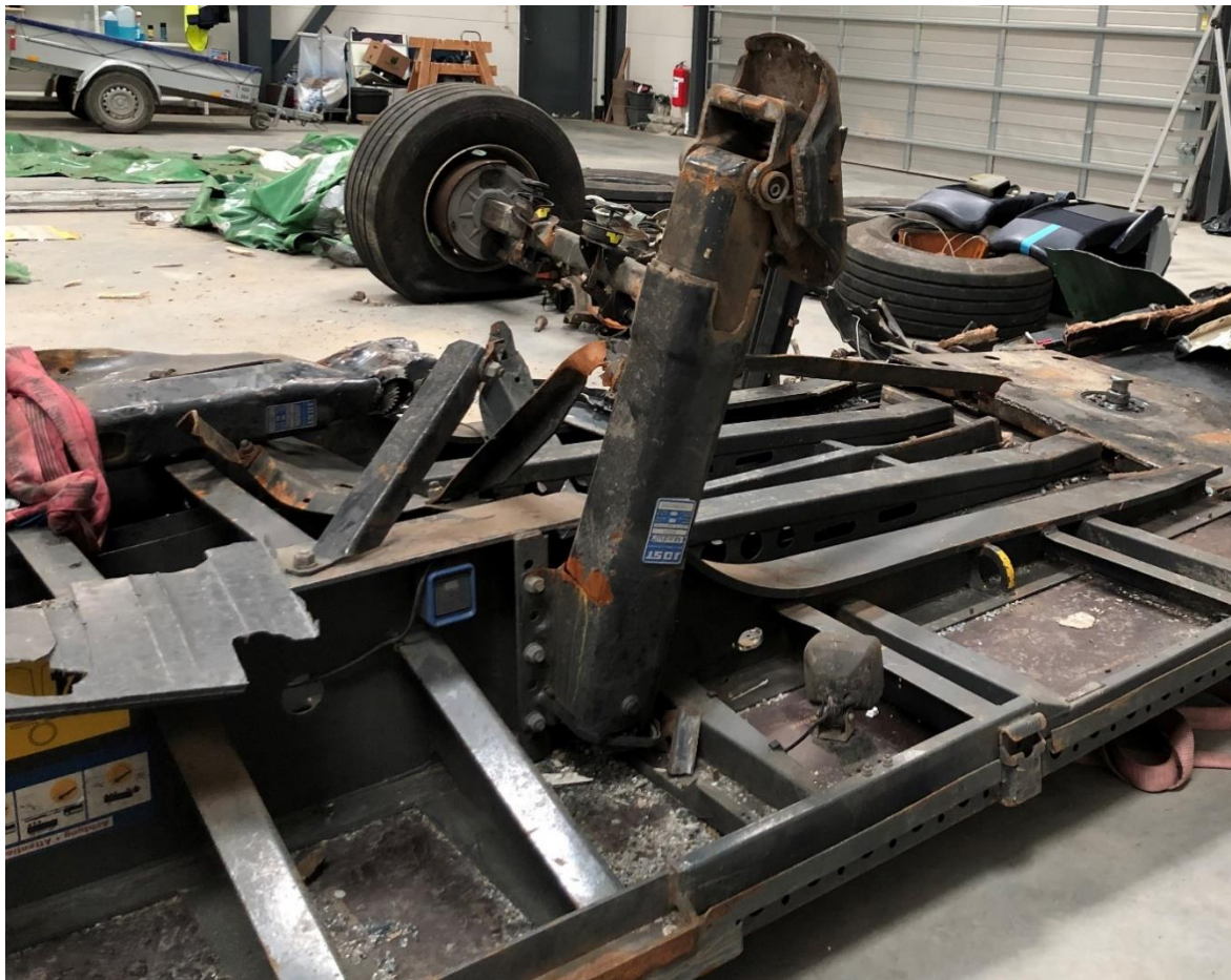
Figur 63: Beskadiget venstre støtteben
