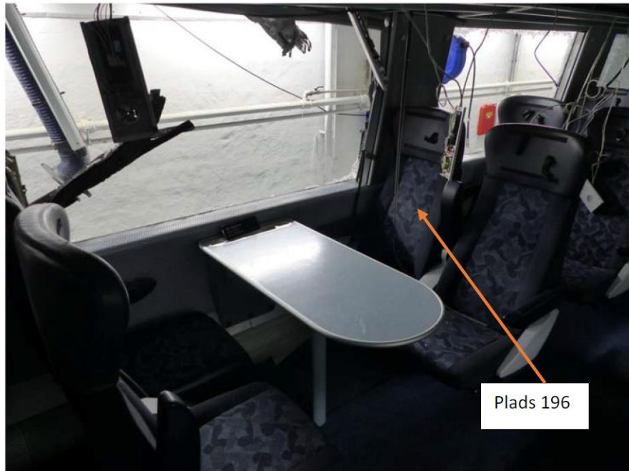
Figur 111: Sæde 196 - deformeret vinduesstolpe
