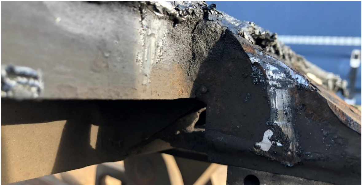
Figur 67: Træktest. Mærker efter hovedbolt foran skammel
