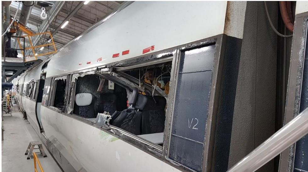
Figur 86: Vinduesstolpe trykket ind mellem vindue 2 og 3
