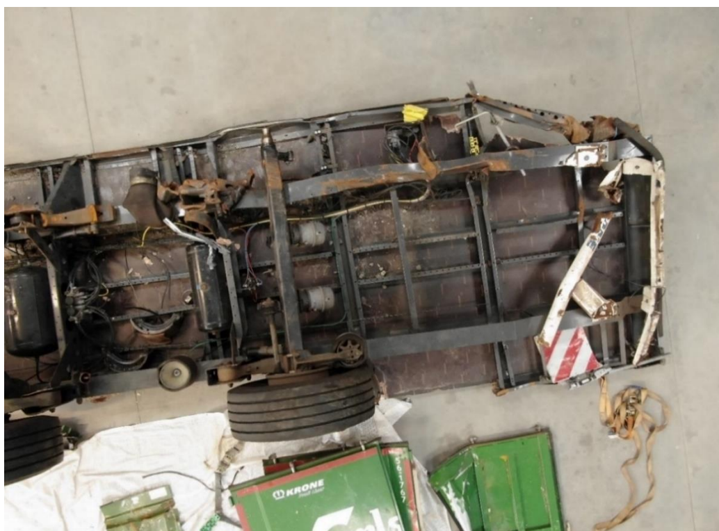
Figur 62: Beskadigelser på bageste del af sættevognstrailer
