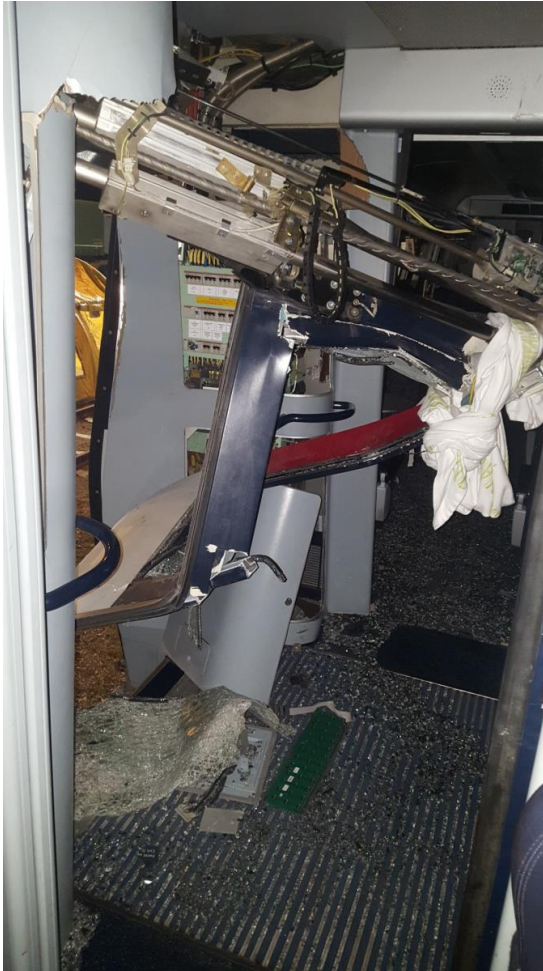
Figur 107: Vogn 2. Skader på indstigningsdøre, venstre side
