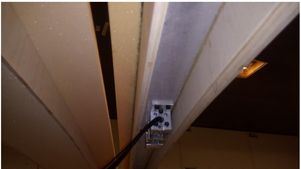
Figur 69: Gauge til måling af kræfter monteret under bromodel og forbundet til togmodel
