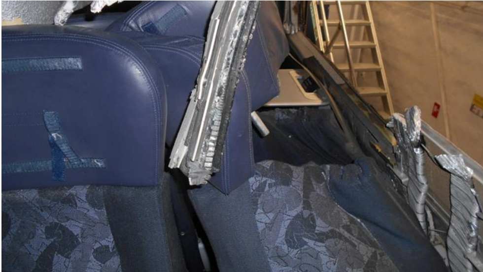
Figur 110: Vinduesstolpe slået ind ved sæde 155
