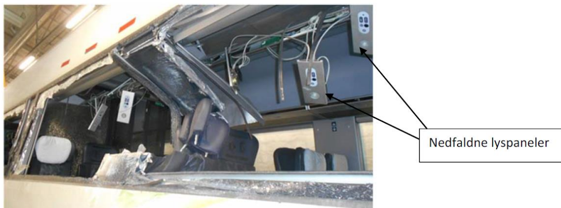
Figur 103: Nedfaldne lyspaneler under bagagehylde
