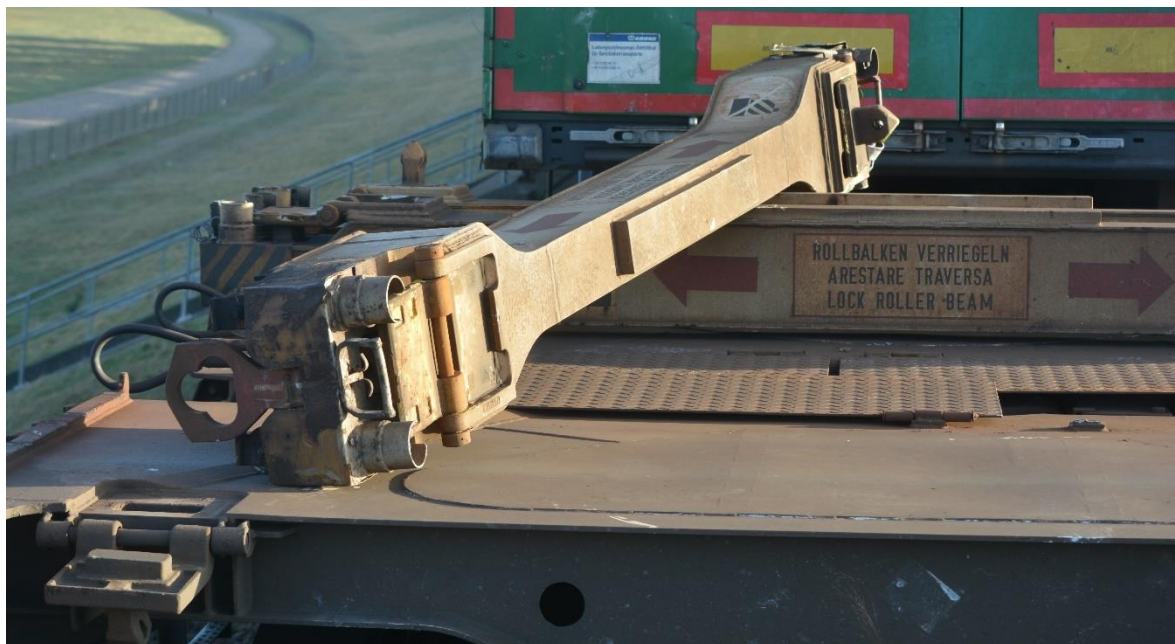
Figur 40: Containerbom revet løs fra sin plads på lommevognen
