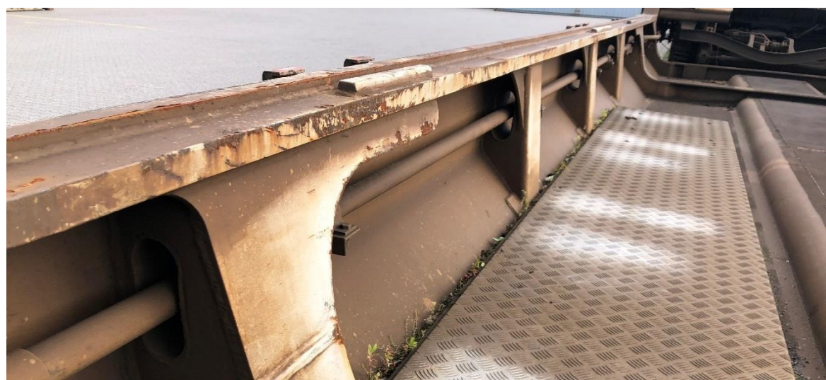
Figur 38: Skader på lommevognen
