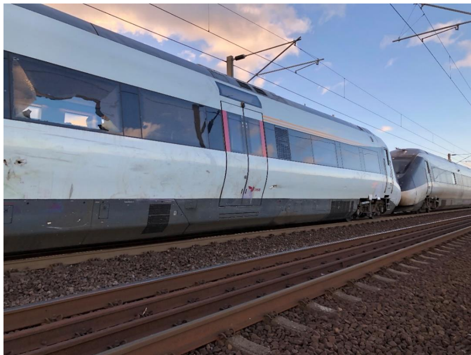
Figur 89: Skader på bageste del af vogn 4
