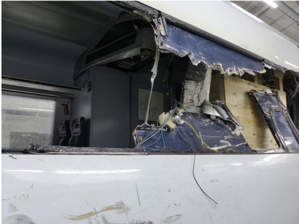
Figur 78: Vognkasseskade i området for indstigningsdør
