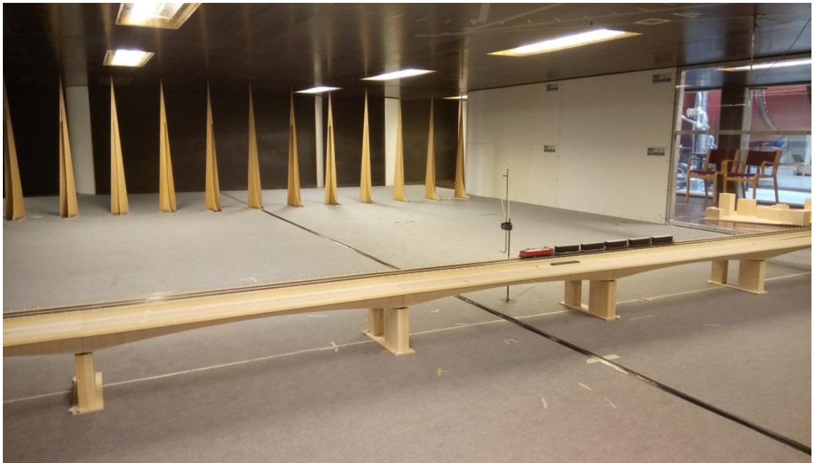
Figur 68: Bromodel med togmodel i vindtunnel
