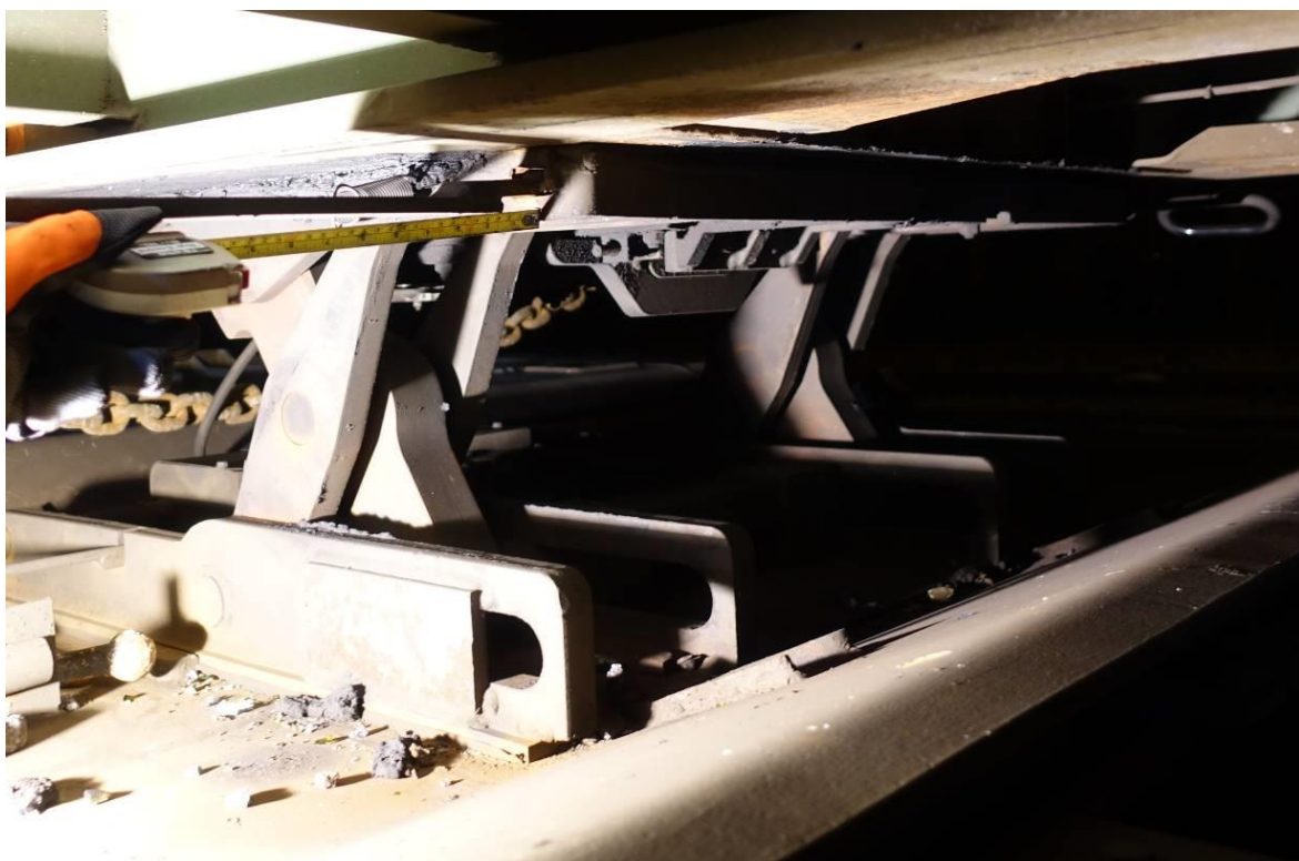
Figur 45: Skammel under sættevognstrailer i position 5. Låsehåndtaget gik trægt
