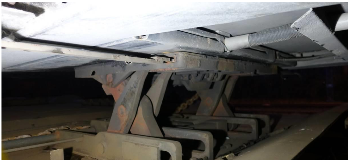
Figur 44: Skammel under sættevognstrailer i position 3. Håndtaget til låsen kunne ikke bevæges
