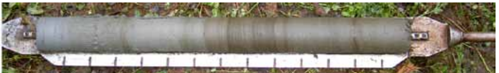
Fig. 4. Borrhävar från en mosse. Kärnans längd är 70 cm med denna provtagare. Isoleringen är belägen något till höger om mitten. Vänster sida av kärnan låg djupast ner, vilket illustreras av den gråaktiga leran som avsattes före isoleringen. Färgskiftningarna i sedimentprovet högra del speglar ändrade vattenkemiska förhållanden då partiklar med förhöjd halt av organiskt material avsattes i sedimentet efter isoleringen.
